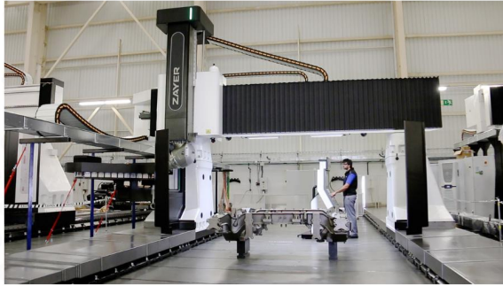
Centre d'usinage gantry - Altea - Zayer (4).webp
