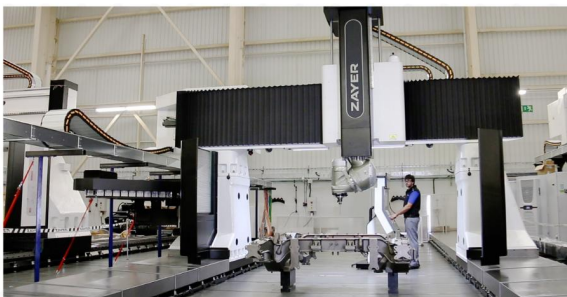
Centre d'usinage gantry - Altea - Zayer (3).webp
