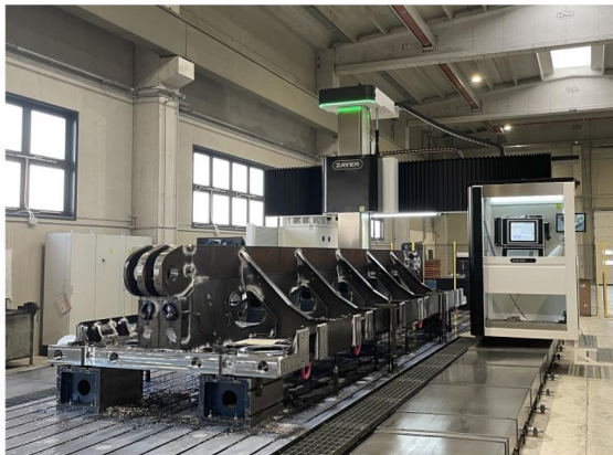
Centre d'usinage gantry - Altea - Zayer (6).webp
